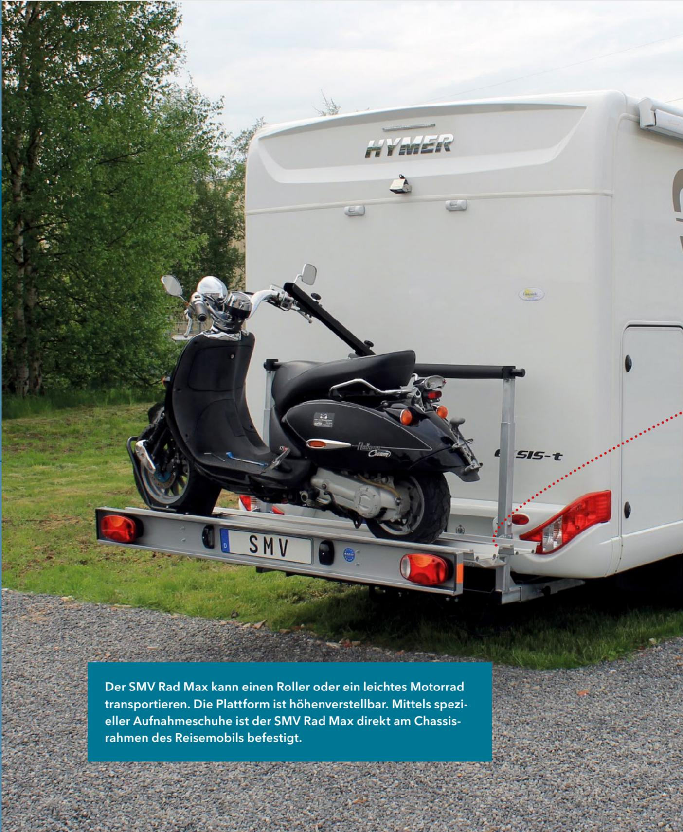
Der SMV Rad Max kann einen Roller oder ein leichtes Motorrad transportieren. Die Plattform ist höhenverstellbar. Mittels spezieller Aufnahmeschuhe ist der SMV Rad Max direkt am Chassisrahmen des Reisemobils befestigt.
